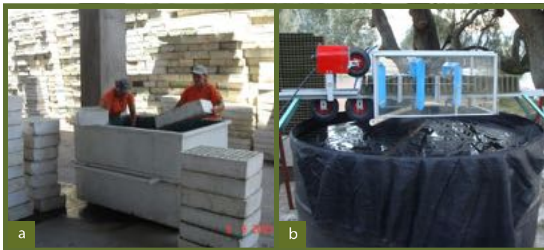
Figura 19. Lavado manual (a) y mecanizado (b) de charolas de poliestireno y plástico.
